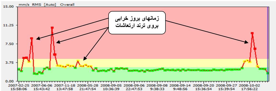
شکل ۲: روند تغییرات ارتعاشات در پمپ P-2102-A
